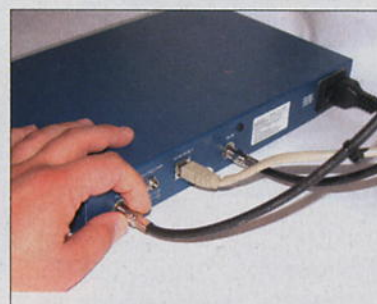
Jetzt nur noch Sende- und Empfangskabel zur Sat-Anlage sowie das Netzwerk an das Modem angeschlossen und es kann losgehen
